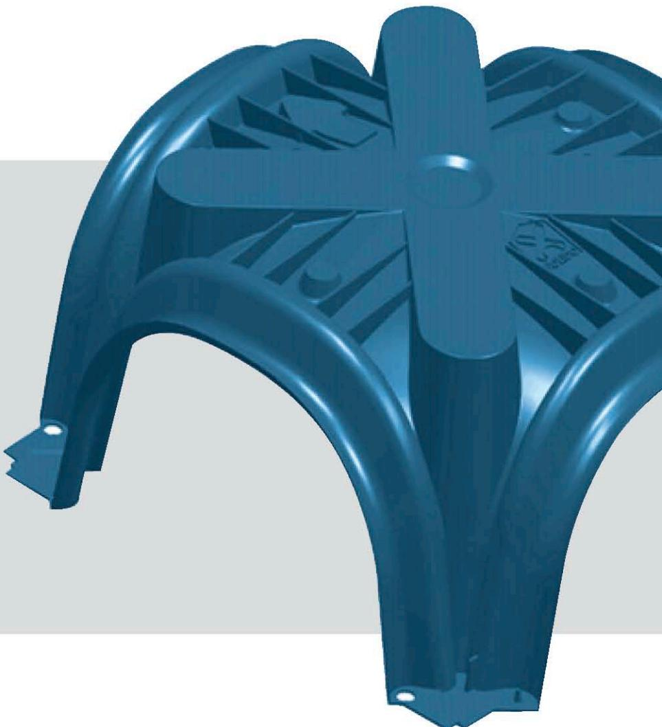
**Solido®** è il cassero a perdere di qualità per la realizzazione di intercapedini (vespai aerati), costituenti una barriera fisica all'umidità tra il terreno ed il fabbricato. Predisponendo una adeguata ventilazione tramite apposite condotte con l'esterno, permette inoltre lo smaltimento del gas Radon verso l'atmosfera.
